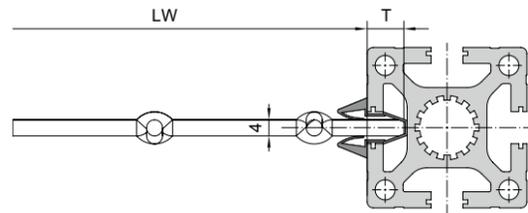
Anwendung mit Einfassprofil C39-70
