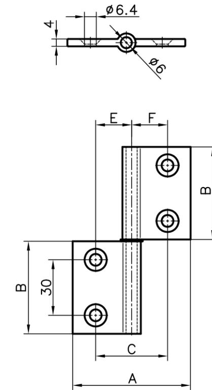
das Flachbandscharnier nicht abmontiert werden kann. Dies kann bei Sicherheitsüberlegungen wichtig sein.
