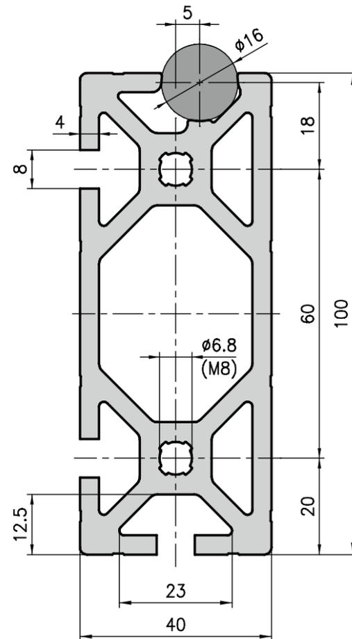
Einen stirnseitigen Anschlag lässt sich an den Löcher  $\varnothing 6.8$  mit einem Gewinde M8 befestigen. Zu dieser Führung müssen die Schlittenplatten oder die Schlittenkonstruktion jeweils spezielle ausgelegt werden, daher sind diese nur auf Anfrage erhältlich.
