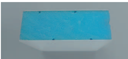
Sandwichpanel mit beidseitiger Kunststoff- oberfläche
