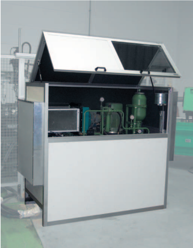
Lärmschutz für Hydraulikaggregat mit Lüftungssystem inklusive Zuluft- und Abluftschalldämpfern, Lärmpegelreduzierung 23 dB(A)
