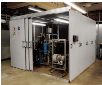
Lärmschutzkabine mit 3-fach-Schiebetür und geregelter Lüftungssystem, geöffnet
