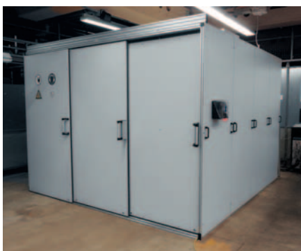
Lärmschutzkabine mit 3-fach-Schiebetür und geregelter Lüftungssystem, geschlossen
