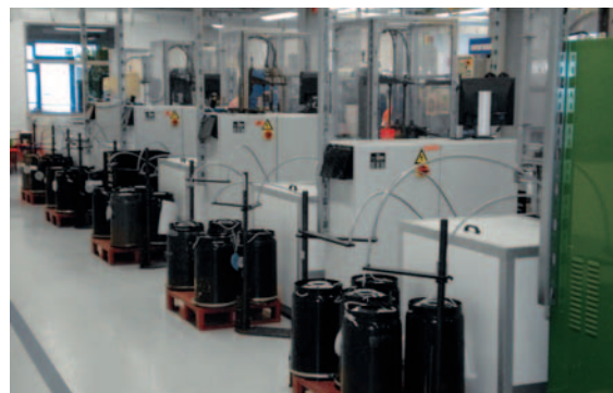
Lärmschutzverkleidung für Wickelmaschinen. Lärmpegelreduzierung 15 dB(A)
