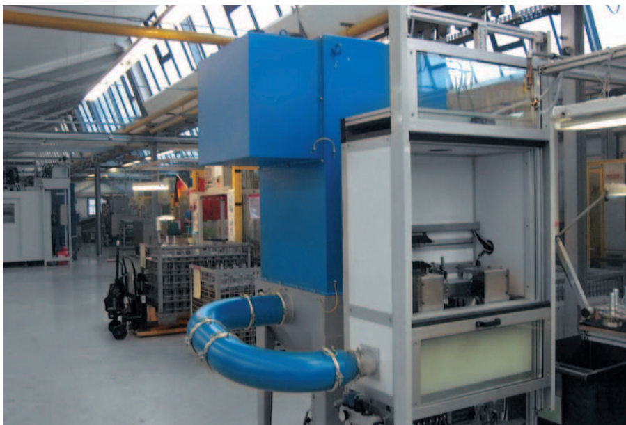
Lärmschutzkabine für Teile-Reinigung mittels Druckluft
