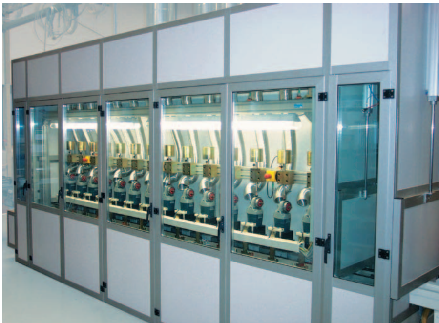
Dauerlaufpruefstand fuer 2-Hand-Winkelschleifer mit Laermschutzschleusen fuer Werkstuecktraeger, Laermpiegelreduzierung 28 dB (A)
